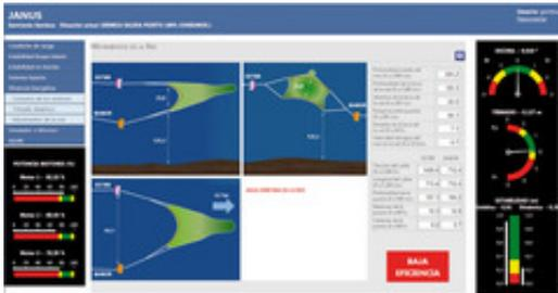
Janus Systems S.L. presenta su sistema de seguridad y ecoeficiencia energética para buques, un software naval que se puede instalar en todo tipo de buques. El sistema permite controlar la estabilidad y la resistencia longitudinal del buque en tiempo real; alerta de los riesgos en la mar, da respuestas a las emergencias y apoya las decisiones; optimiza la eficiencia energética con un ahorro de hasta un 10 % en el consumo de combustible; y permite controlar desde tierra las incidencias,
